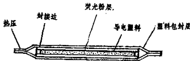
图 4-21 EL 的结构及原理
