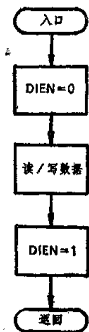
图 11-6 MPU 直接访问的程序流程图
