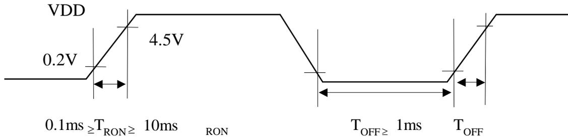
2、如果电路电源不能满足内部 RESET 电路的要求的话，需要用初始化程序来实现初始化。过程如下：
