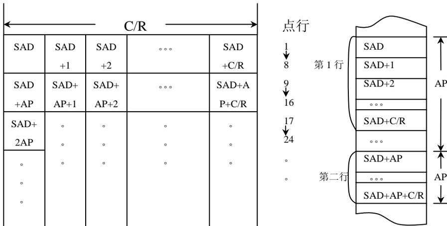
下表以 W/S=0, FX=8 为例列出图形方式下一个显示区与显示缓冲区的关系 (SAD 为此区首地址)::
