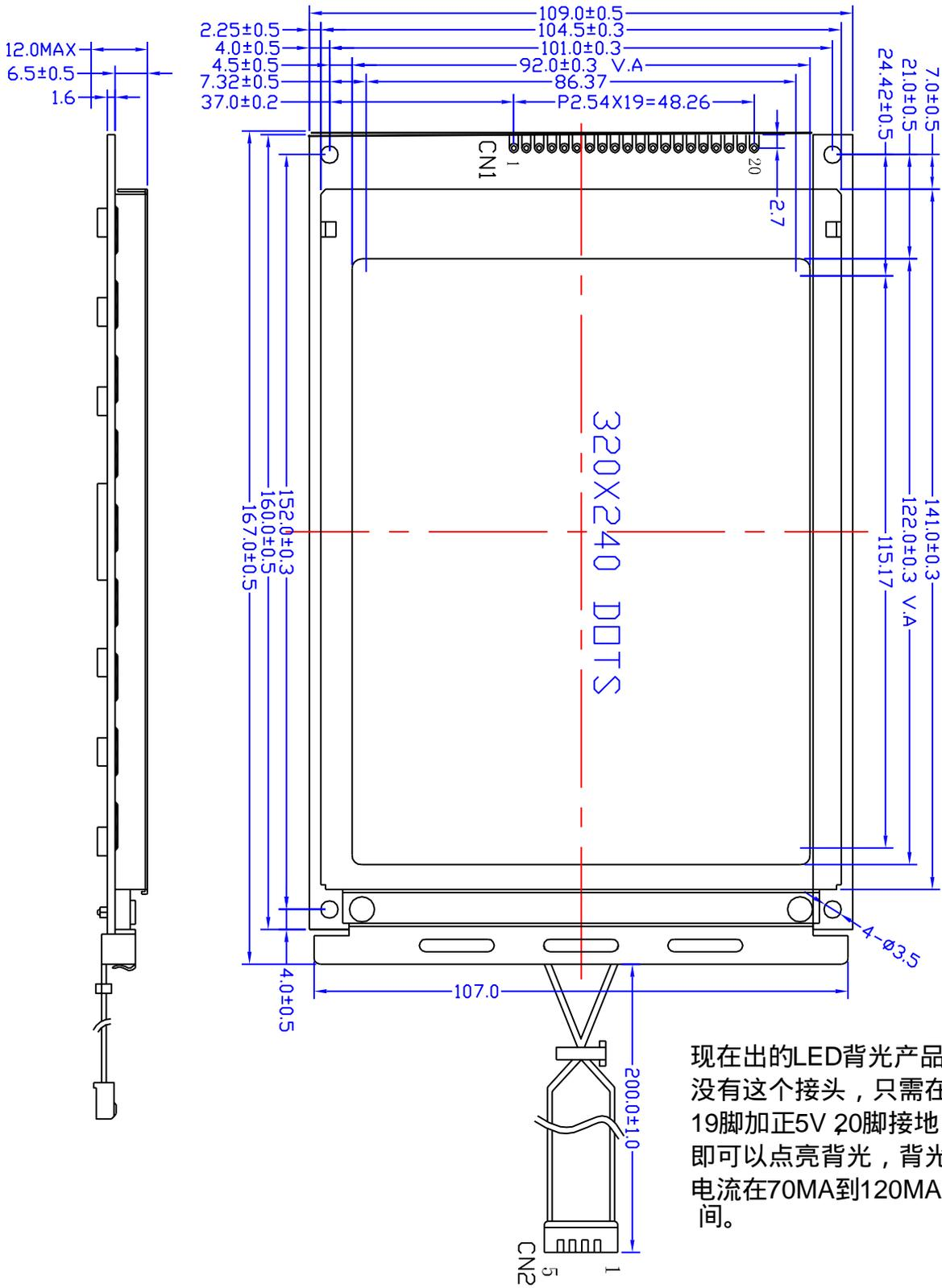
现在出的LED背光产品没有这个接头，只需在19脚加正5V 20脚接地即可以点亮背光，背光电流在70MA到120MA之间。
