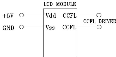
现在出的LED背光产品，就没有这个接线，只需在19脚加正5V，20脚加地即可点亮背光，也可用开关电路控制背光。在外形上，附属的铁框外框也相应减小，可以索要最新单页图参考。
